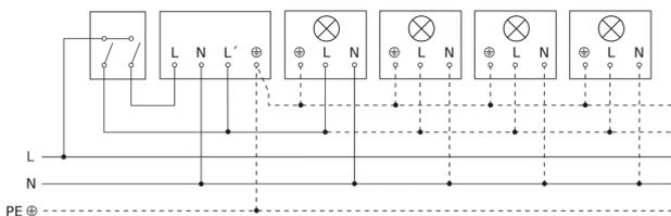
**Schéma de câblage Raccordement via un commutateur pour l'éclairage permanent et le mode automatique**
